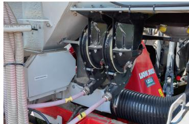
Über vier Aggregate an der Unterseite des Saatguttanks werden die Maiskörner abgelegt, die über die zentrale Verteilung mit Dünger versorgt werden.
